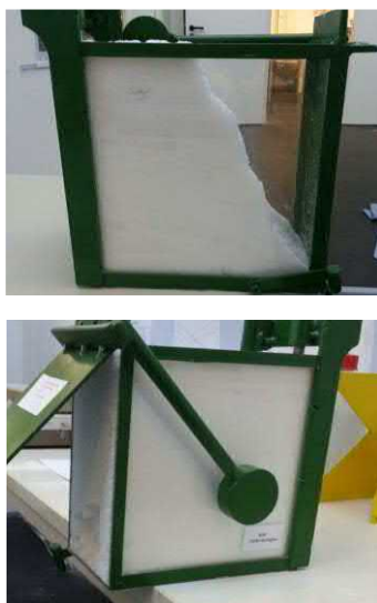
Abbildung 13: Prüfung der Rieselfähigkeit mit der Auslaufbox nach Sonntag und Einfluss des Feuchtegehaltes
