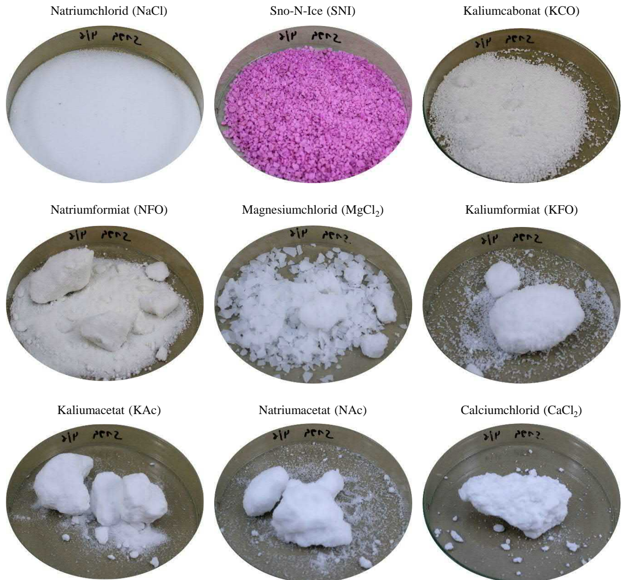
Abbildung 14: Optischer Vergleich verschiedener Taumittel nach längerer Lagerung an der Luft
