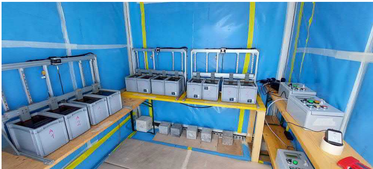
Abbildung 43: Drei Wechseltauchprüfungsstände (WT) im Klimacontainer (CT) von WINTERLIFE
