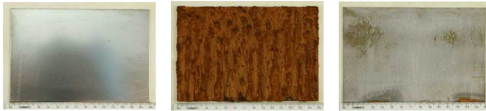
Abbildung 85: Optischer Vergleich der Grundtaumittel auf Stahl (Fe)
