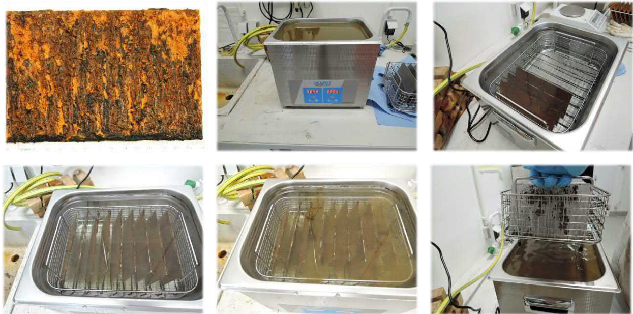
Abbildung 41: Reinigung der Proben im Ultraschallbad zur Bestimmung des Gewichtsverlustes
